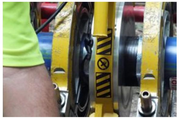
On dispose, sur la machine d'une râpe qui va ajuster les rebords du tube.
